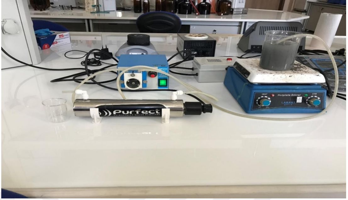
Şekil 3.6. Tekstil atık suyu arıtımında kullanılan UV/H 2 O 2 prosesi deney düzeneği.
