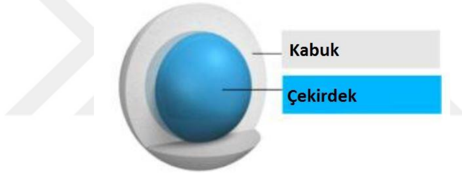
Şekil 2.1 Mikrokapsülün yapısı (İnt. Kyn.1).
