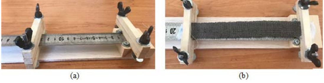
Şekil 3.1 Uzama Ölçüm Düzenekleri a) Uzama ölçüm düzeneği b) Ölçüm sırasındaki düzenek (Kişisel arşiv, 2019)
