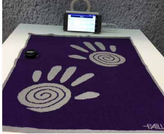
Şekil 1.7 Pailung firmasının ürettiği EKG, solunum ve kalp hızı ölçen kumaş (Kişisel arşiv, 2017)
