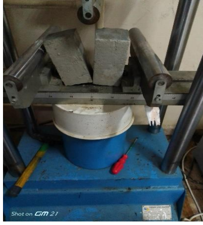
Şekil 33: Betonun Eğilme Dayanımı Ölçümü
