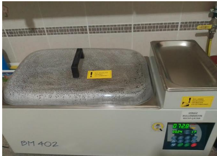
Şekil 34: Atmosferik Buhar Kürü Uygulanan Cihaza Ait Resim
