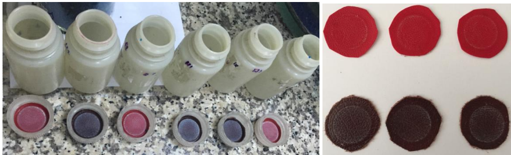
Şekil 6.7 Numunelerin su buharı geçirgenliği testi sonrasındaki görünüşleri (Kişisel arşiv, 2015)
