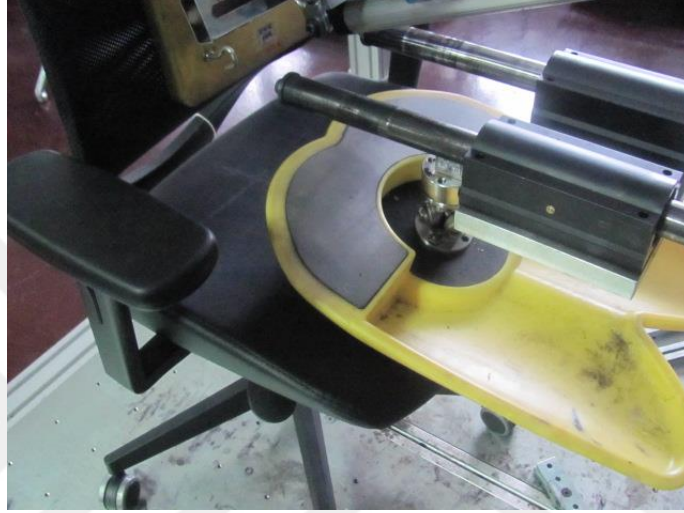
Şekil 5.10 Oturma yeri ön köşe statik yük testi (Kişisel arşiv, 2015)
