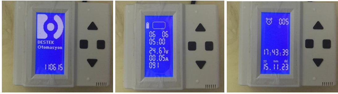
Şekil 4.8 Kumanda ünitesi logo ekranı, ayar ekranı ve saat ve tarih ekranı görüntüsü (soldan sağa doğru) (Kişisel arşiv, 2014)
