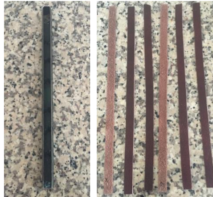
Şekil 6.11 Soldan sağa kalıcı uzama set tayini şablon bıçağı ve numuneleri (Kişisel arşiv, 2015)
