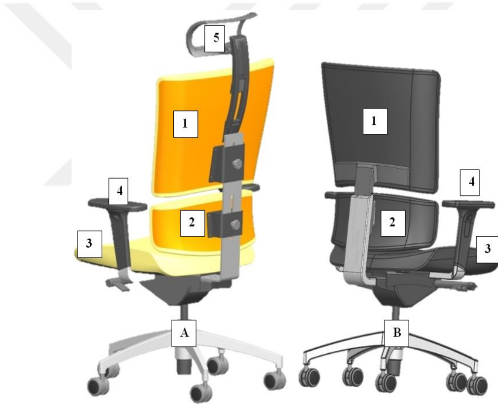
Şekil 4.14 Klasik arkalık taşıyıcı ve iki ayar mekanizmasına sahip arkalık taşıyıcının koltuk üzerindeki görünüşü (soldan sağa doğru)
