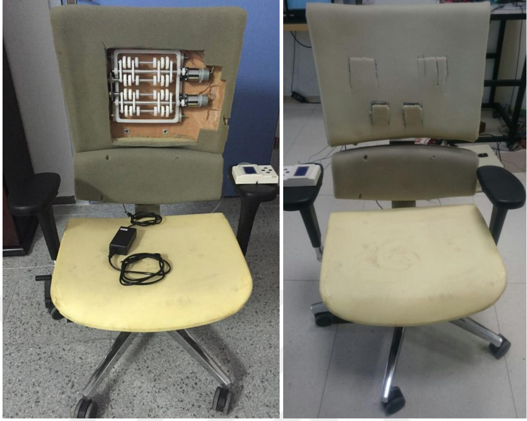
Şekil 4.7 İki farklı masaj mekanizmasını içeren prototip fotoğrafları (Kişisel arşiv, 2014)
