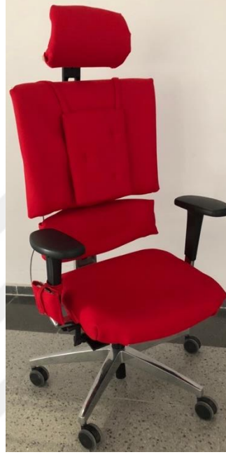
Şekil 7.2 Yoğurma masajı yapan büro koltuğu prototipi (Kişisel arşiv, 2017)
