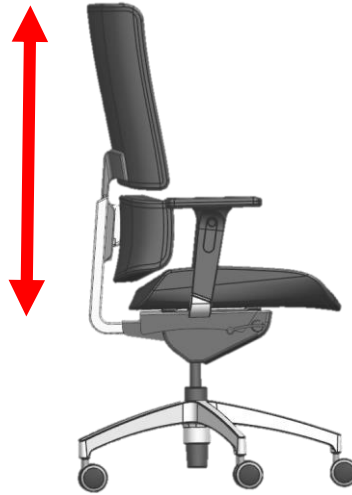
Şekil 4.15 B modeli için arkalık yükseklik ayar mekanizması
