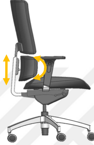
Şekil 4.18 B modeli için bel desteği yükseklik ayar mekanizması
