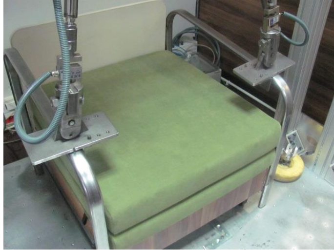
Şekil 5.11 Statik kolçak testi (dikey) (Kişisel arşiv, 2015)
