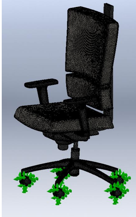
Şekil 5.3 Doğal frekans analizi için koltuğa mesh atama işlemi
