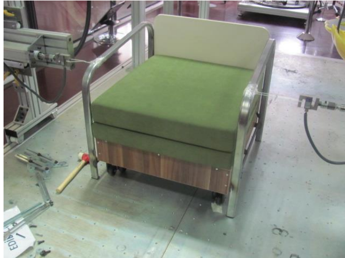
Şekil 5.12 Statik kolçak testi (yatay) (Kişisel arşiv, 2015)
