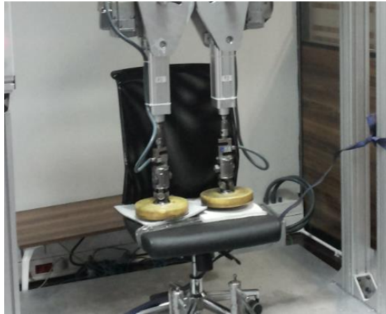
Şekil 5.14 Oturak kenarı mukavemet testi (Kişisel arşiv, 2015)
