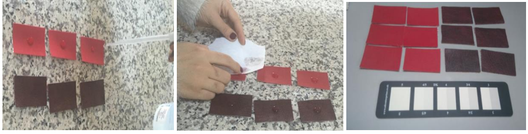
Şekil 6.16 Su ile lekelenmeye karşı renk haslığı testinin yapıışı ve numunelerin değeriendirilmesi (Kişisel arşiv, 2015)
