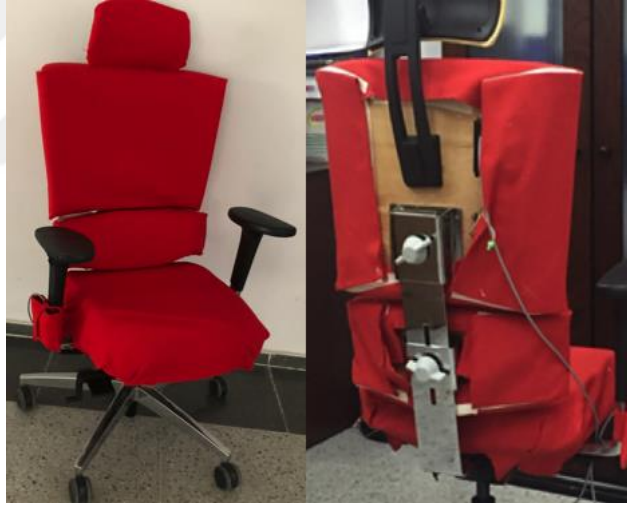
Şekil 7.1 Titreşim masajı yapan büro koltuğu prototipinin ön ve arkadan görüntüsü (Kişisel arşiv, 2017)
