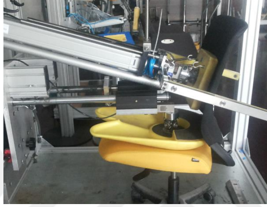
Şekil 5.13 Oturma yüzeyi ortasına ömür testi (Kişisel arşiv, 2015)
