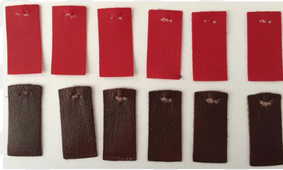
Şekil 6.10 Dikiş yırtılma dayanımı tayini için alınan örnek boyutları ve yırtılma sonrası numuneler (Kişisel arşiv, 2015)
