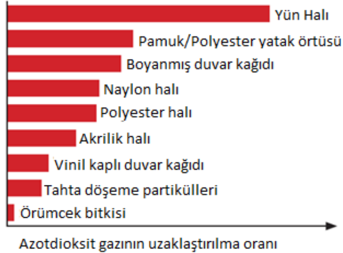
Şekil 2.2 Çeşitli malzemelerin NO 2 'yi uzaklaştırma oranları [5]
