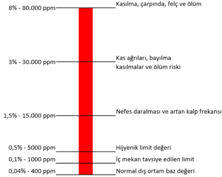
Şekil 3.5. CO 2 Konsantrasyonu ve Havalandırma İhtiyacı İlişkisi (ISKİD 2024).
