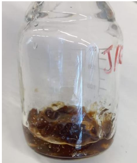
Şekil 2.2 : %4 derişime sahip glutaraldehit ile modifiye edilmiş jelatin stok çözeltisi.
