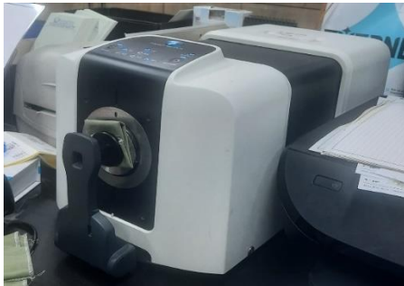
Şekil 2.7 : Boya alımı değerlendirmek için yapılan spektrofotometre ölçümü.
