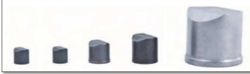
Şekil 2.8. US-MIL-P-46593'te tanımlanan parçalamayı taklit edici parçacıklar (Fragment Simulating Projectiles) (www. bodyarmornews.com, 2019).
