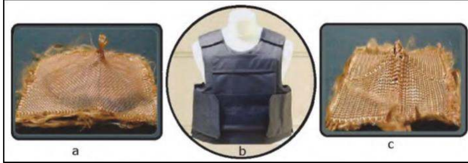
Şekil 3.18. a) Darbe hasarı sonrası 3 katmanlı iki boyutlu PBO (Zylon®) lifli kumaş, b) Darbe hasarı sonrası PBO lif içeren balistik koruma sağlayan yelek (Kalaycı ve ark. 2015b ), c) 3 boyutlu ortogonal PBO (Zylon®) lifli kumaş (Behera ve Dash, 2013; Yumak ve ark. 2013)
