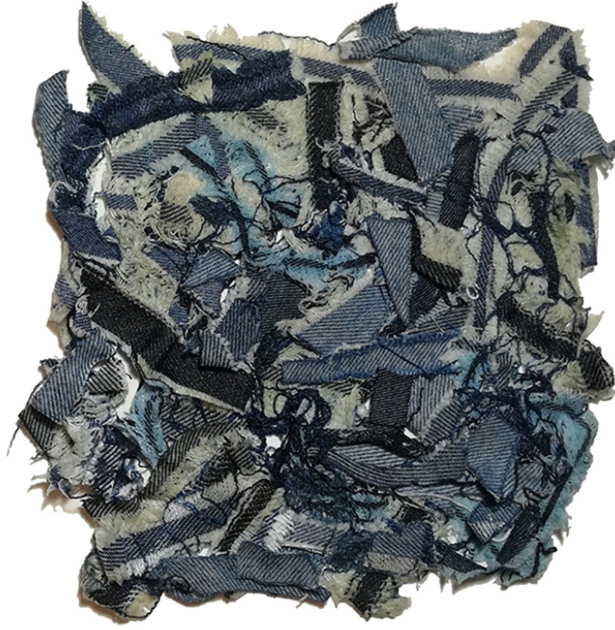
Şekil 50- Binder Miktarının Etkisinin İncelenmesi, Deneme 5, Uygulama 1
