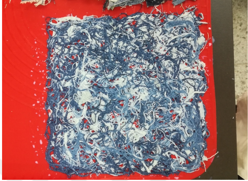
Şekil 42- Fazla Çözeltinin Sıkılarak Mat Üzerinde Etüve Gönderilme Uygulaması
