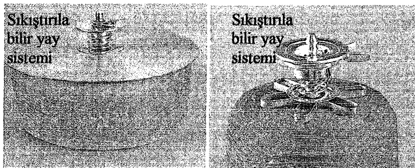
Resim 4.3. Silindirik ve Konik Bobinde Üst Kapak ve Kitleme Sistemi
