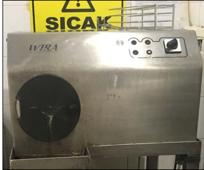
Şekil 3.2. WIRA buhar stabilitesi test cihazı
