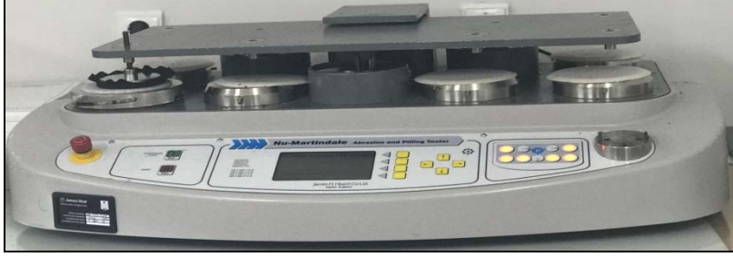
Şekil 3.4. Aşınma ve pilling test cihazı
