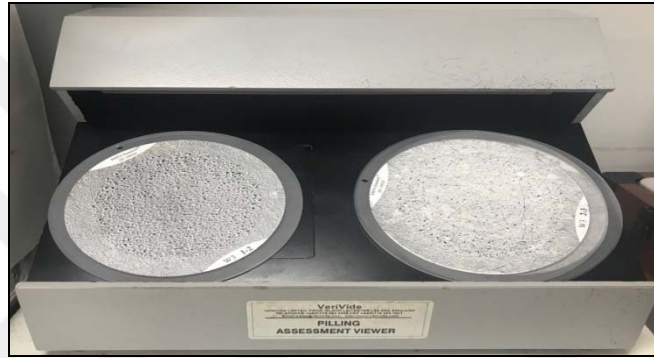
Şekil 3.5. Pilling test değerlendirme cihazı
