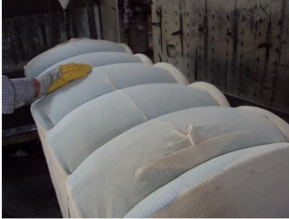
Şekil 4.17. Pres makinesinden çıkarılan bir balya (Çukobirlik,2009)
