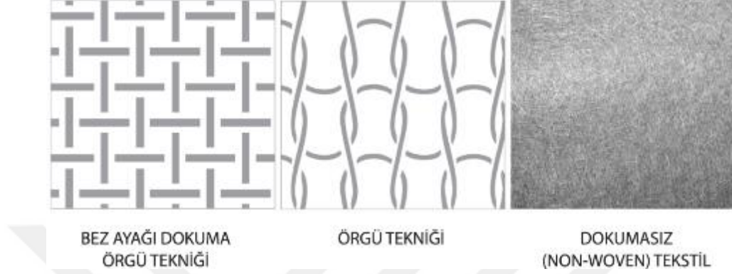
Şekil 24. Dokuma Örgü Tekniği, Örgü Tekniği ve Dokumasız Tekstil (Simonsen Degn vd, 2007; aktaran Wærsted,2014)
