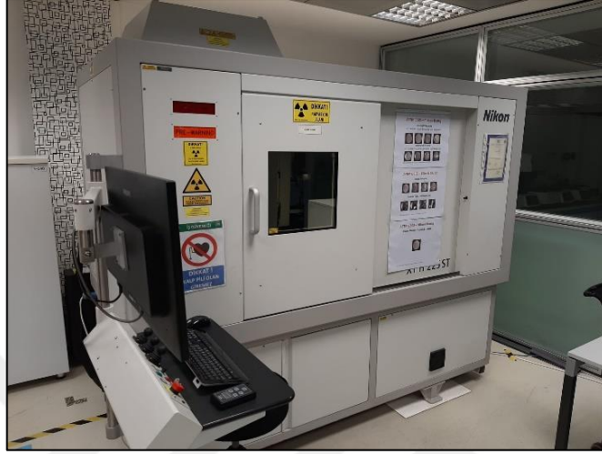
Şekil 3.19 : Nikon XT H 225 ST X-Ray Çekim Makinası.
