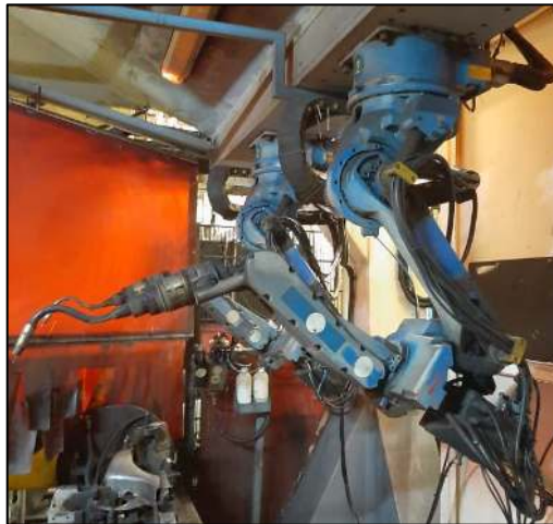
Şekil 3.6 : Motoman EA-1400N Robot Resmi.
