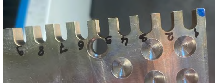
Şekil 3. 2. İşlenmiş Inconel 718 iş parçası
