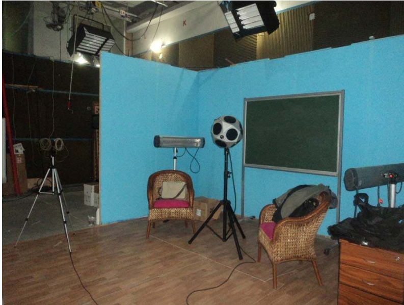
Resim 3.18. 3. kaynak ve alıcı konumu için reverberasyon süresi ölçümü
