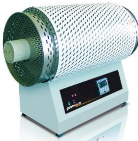
Şekil 3.4. 0-1200 °C ayarlı Protherm PTF 12/75/800 tüp fırın (Batman Üniversitesi).
