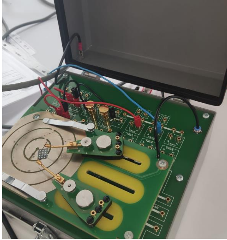
Şekil 3.5. MOS yapıların elektriksel ölçümlerin gerçekleştirildiği kapalı kutu (Batman Üniversitesi).
