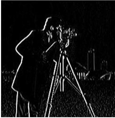
Şekil 5.16: Matlab yatay eksen prewitt operatorünün kameraman üzerindeki etkisi.
