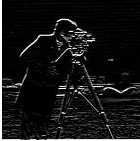
Şekil 5.9: Dikey eksen prewitt operatorünün kameraman resmi üzerindeki etkisi.
