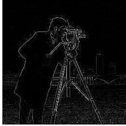
Şekil 5.18: Matlab LoG dönüşümünün kameraman resmi üzerindeki etkisi.
