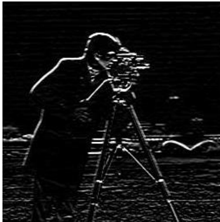
Şekil 5.17: Matlab dikey eksen prewitt operatorünün kameraman üzerindeki etkisi.
