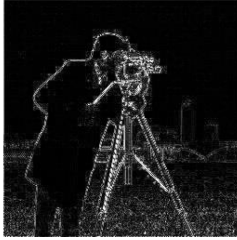
Şekil 5.11: LoG dönüşümünün kameraman resmi üzerindeki etkisi.
