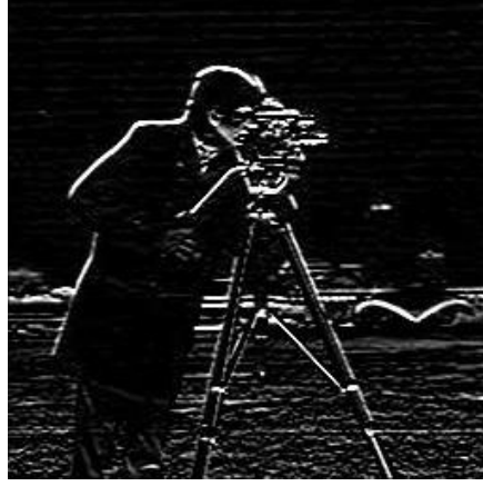
Şekil 5.15: Matlab dikey eksen sobel operatorünün kameraman üzerindeki etkisi.
