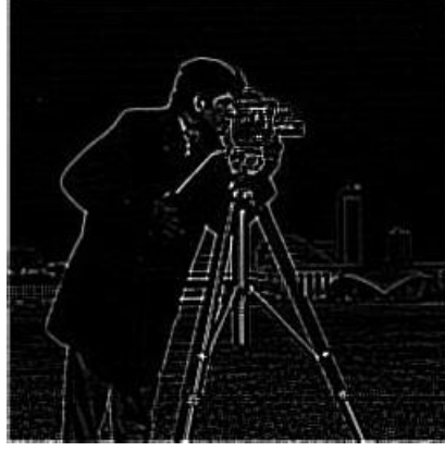
Şekil 5.20: Matlab Canny algoritmasının kameraman resmi üzerindeki etkisi.
