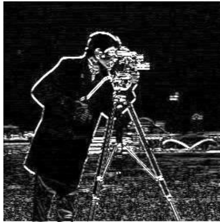
Şekil 5.5: Dikey eksen sobel operatorünün kameraman resmi üzerindeki etkisi.
