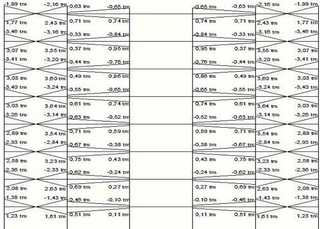
Şekil 3.18 Ankastre temelli yapı için deprem yüklemesi sonucu oluşan kiriş eğilme momentleri
