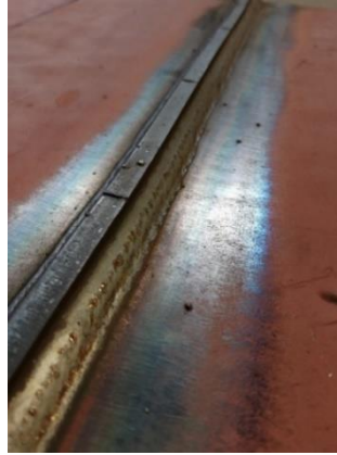
Şekil 63. Kaynaklı parça görsel muayenesi
