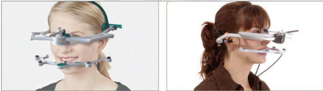
Şekil 2-21: Ultrasonik Çene Hareketi Analizi Yapan Cihazlar (zebris.de, kavo.com)
