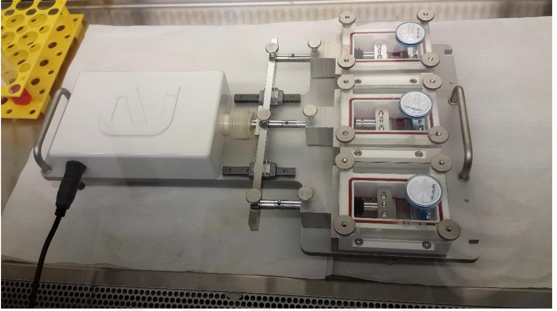
Şekil 3.4. Malzeme yerleştirilmesi ile kurulumu tamamlanmış çalışmaya hazır biyoreaktör
