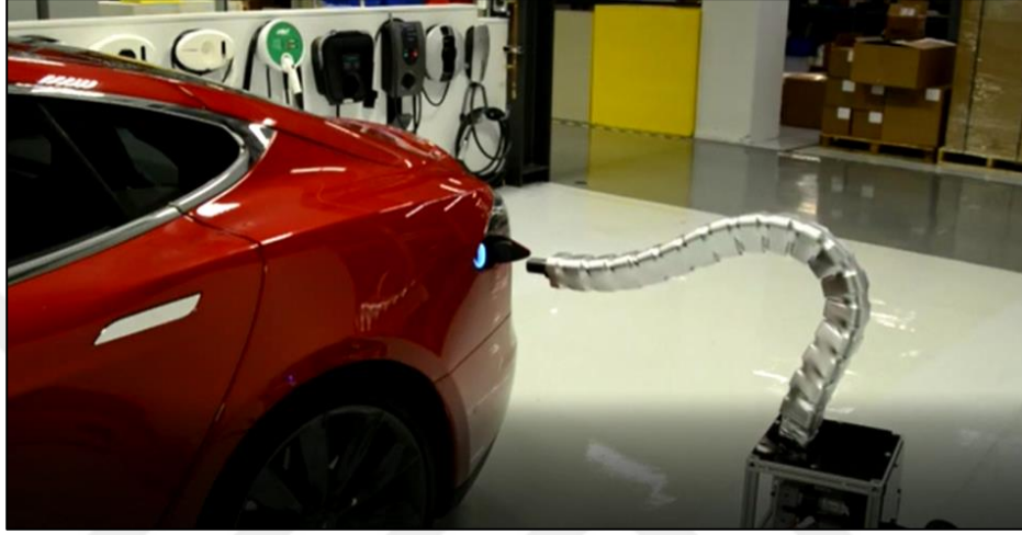
Şekil 2.1.12. Tesla İnsansız Araç Şarj Robotu (CBC, 2015)
