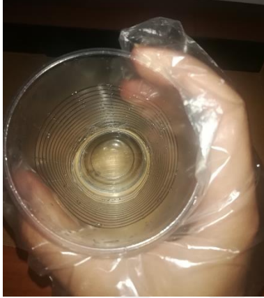
Resim 3.2. Reçine ve sertleştiricinin şeffaf karışımı
