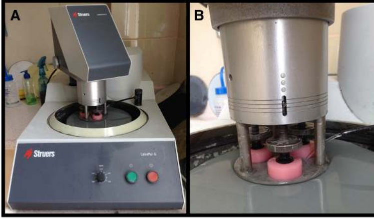
Resim 0-2: A. Struers LaboPol-5 cilalama cihazı B. Örneklerin 3'lü gruplar halinde cihaza yerleştirilmesi
