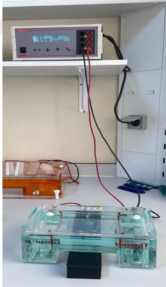
Şekil 3.3. Agaroz jel elektroforez düzeneği
