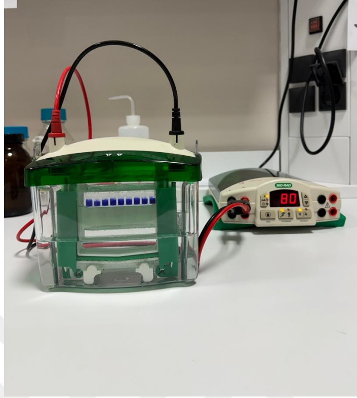
Şekil 3.5. SDS-PAGE jel elektroforez düzeneği
