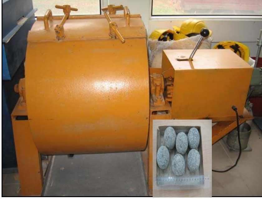
Şekil 2.27. Los Angeles deney aleti ve kullanılan bilyelerin görünümü
