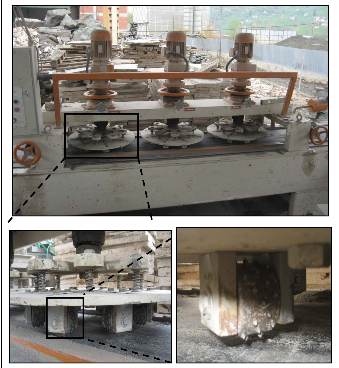
Şekil 3.24. Çekiçleme makinesi ve sert uçların görünümü
