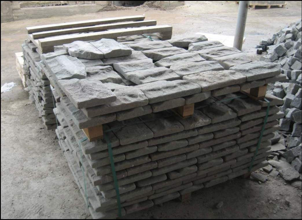
Şekil 3.21. Eskitme uygulanmış taşların görünümü
