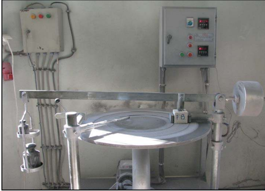
Şekil 2. 14. Sürtünme ile aşınma kaybı deney aleti düzeneği
