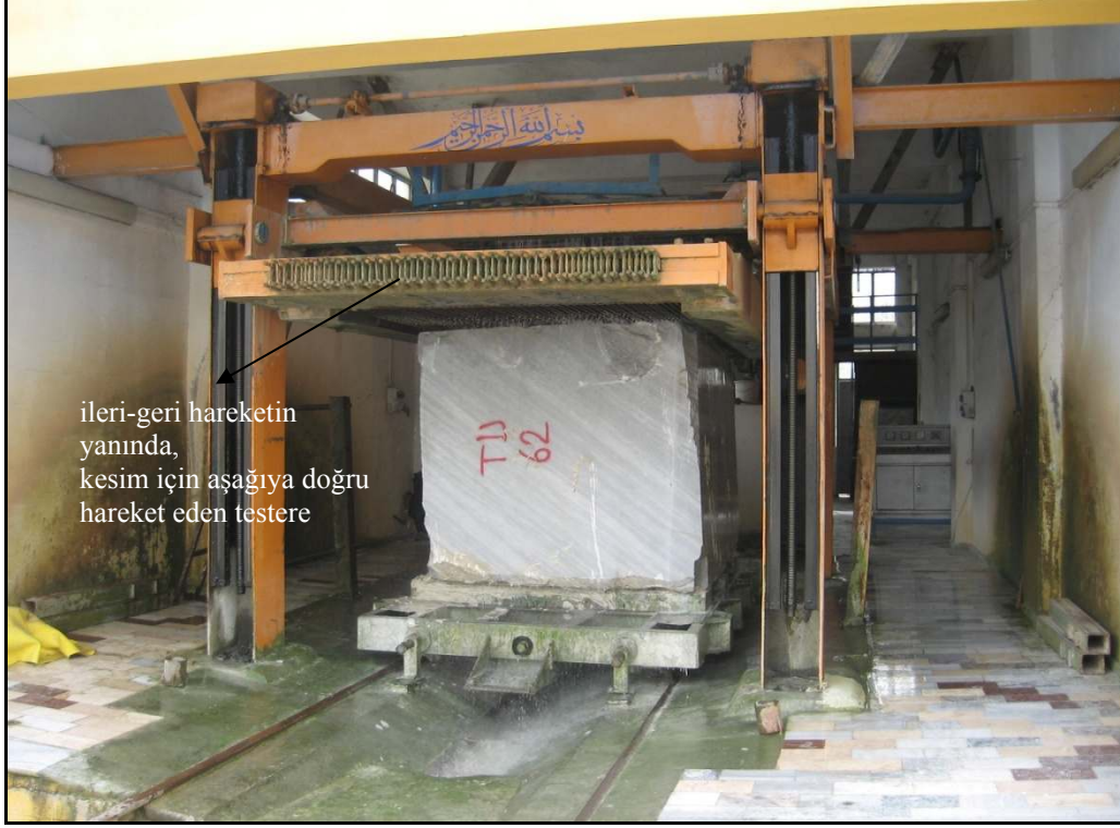
Şekil 3.14. Birinci tip kesim işleminde katrağın önden görünümü
