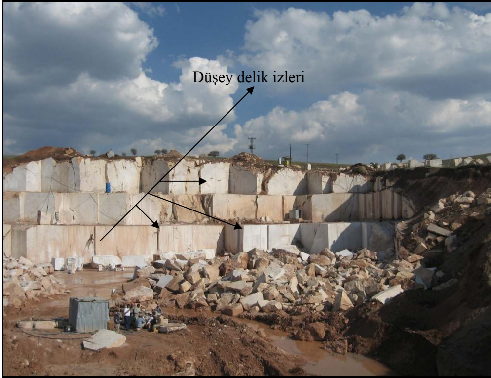
Şekil 3.10. Üretim aşamasında bloktaki düşey delinen delik izleri
