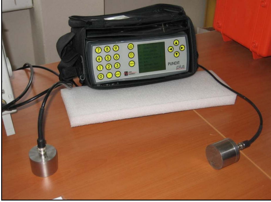
Şekil 2.6. Ultrasonik deney aleti
