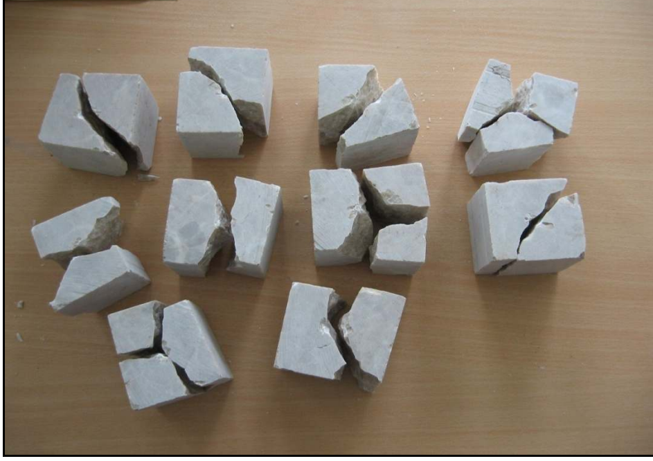
Şekil 2.20. Nokta yük deneyi sonucu kırılmış örneklerin görünümü
