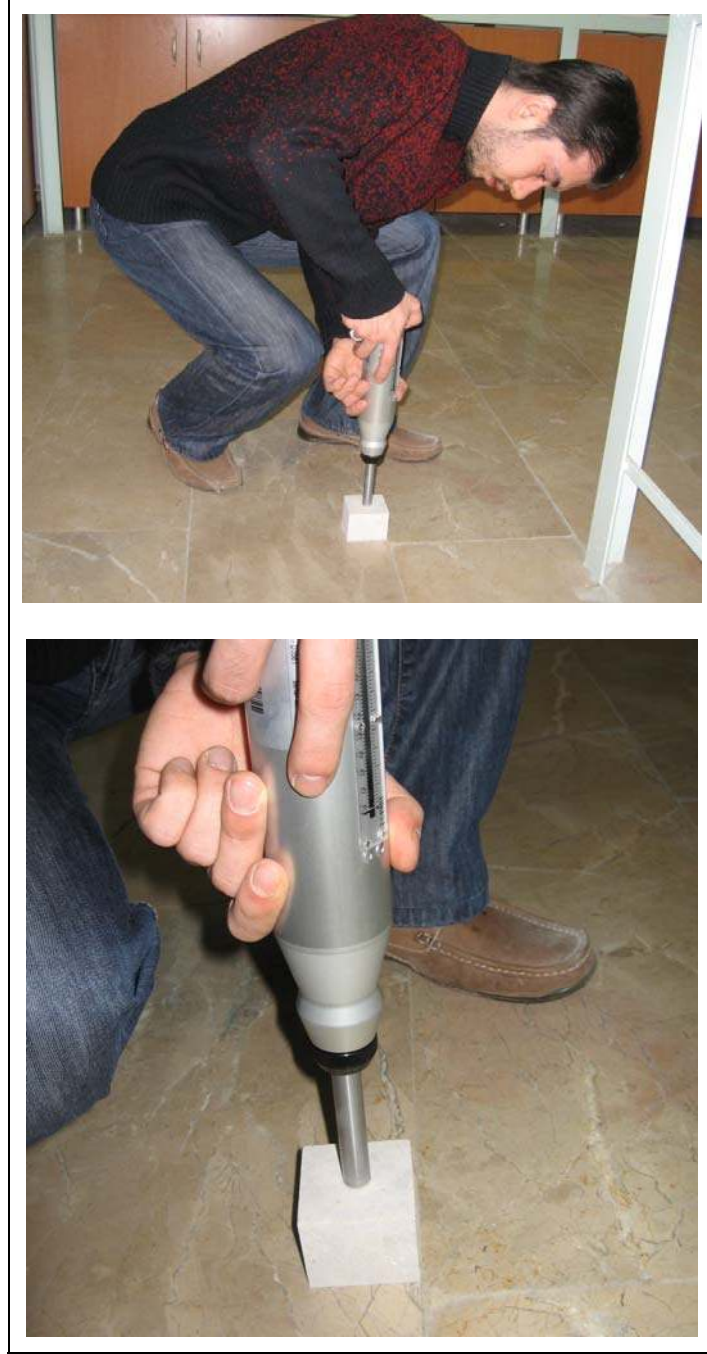
Şekil 2.3. Sertlik derecesi (Schmidt çekici)'nin belirlenmesi
