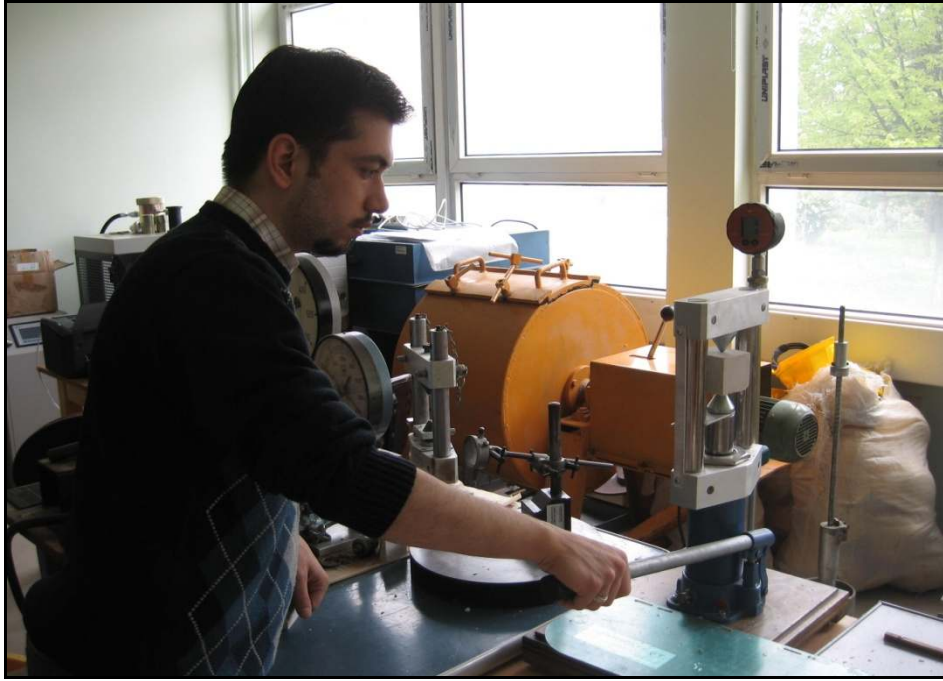
Şekil 2.19. Nokta yük deneyinin yapılışı
