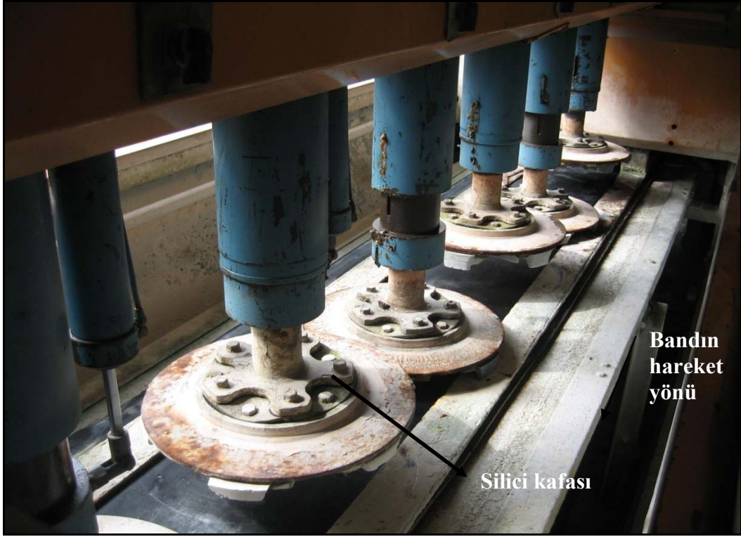
Şekil 3.17. Cila makinesi ve kullanılan silici kafaların görünümü
