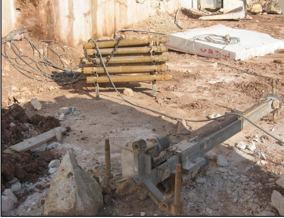
Şekil 3.9. Bloкта delikler açmada kullanılan sondaj alet kısımları
