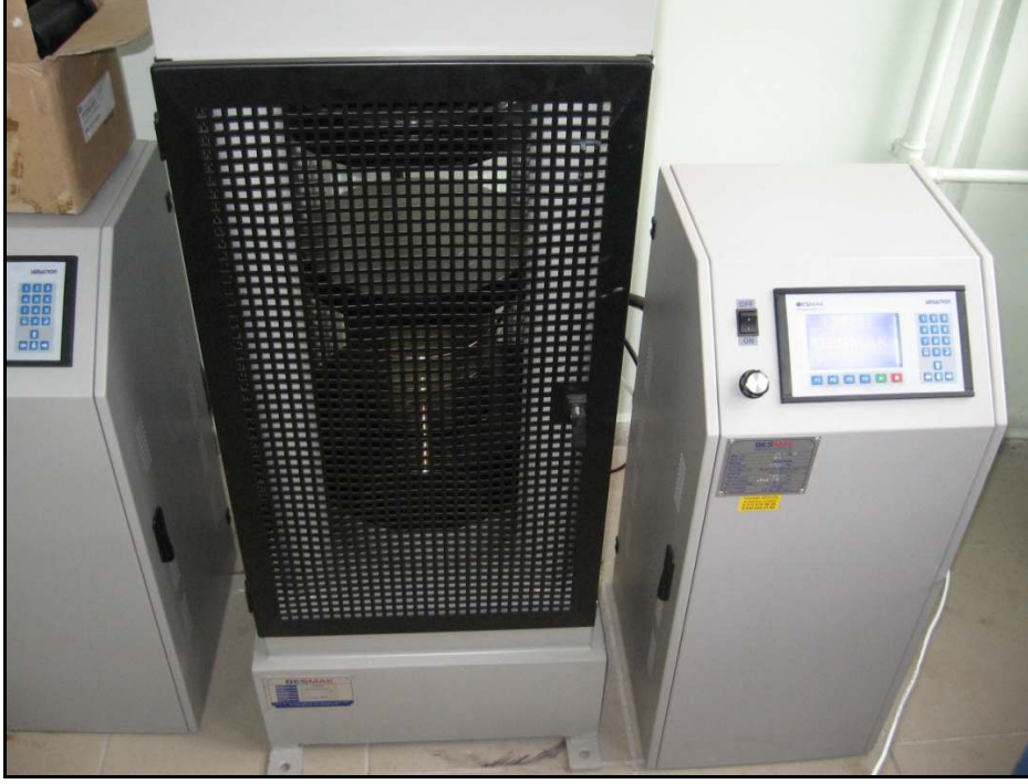
Şekil 2.7. Tek eksenli basınç dayanımı belirlemede kullanılan deney aleti
