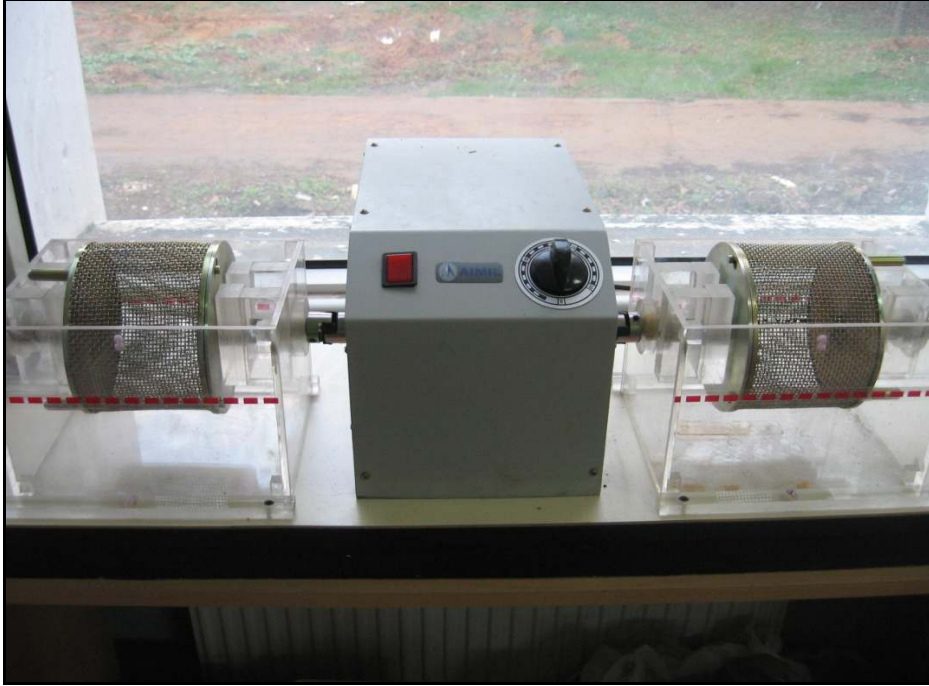
Şekil 2.25. Suda dağılmaya karşı duyarlılık deney aleti düzeneği
