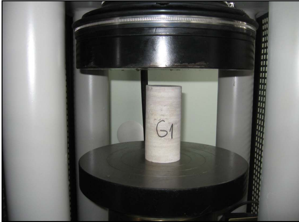
Şekil 2.8. Örneğin deney aletine yerleştirilmesi
