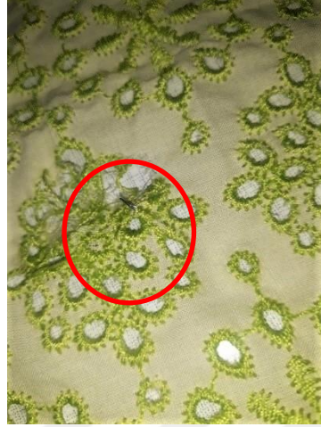
Şekil 4.9. Ürün içine gizlenmiş yabancı cisim.
