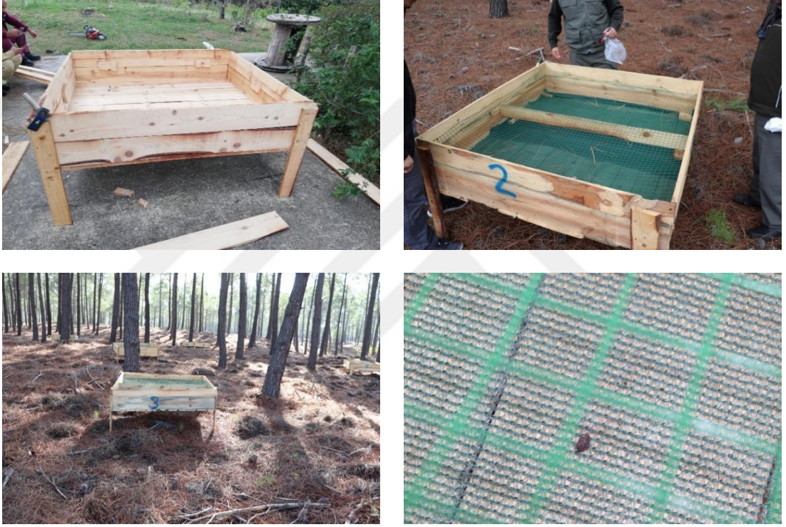
Şekil 9. Tohum kapanların yapımı ve araziye yerleştirilmesi
