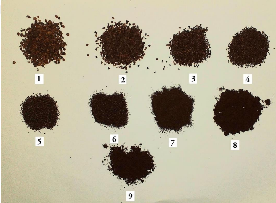
Şekil 3.2. Öğütme ve eleme sonrası elde edilen pirina numuneleri > 1700 \mu\text{m} partikül büyüklüğü (1) 1500-1700 \mu\text{m} (2) 1000-1500 \mu\text{m} (3) 800-1000 \mu\text{m} (4) 500-800 \mu\text{m} (5) 425-500 \mu\text{m} (6) 212-425 \mu\text{m} (7) 180-212 \mu\text{m} (8) < 180 \mu\text{m} (9)
