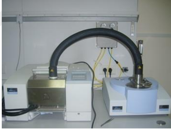
Şekil 3.4. TGA/FTIR entegre analiz cihazı (ODTÜ Merlab)
