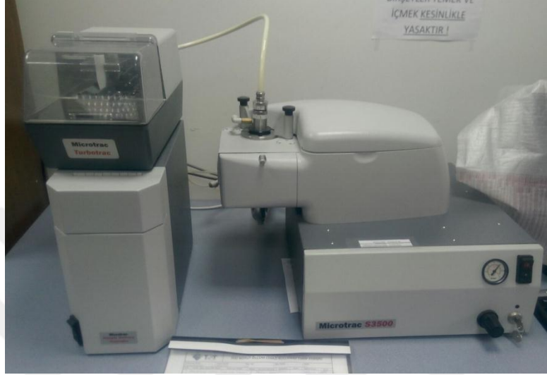
Şekil 5.9. Toz boyut analizi cihazı MICROTRAC S3500.
