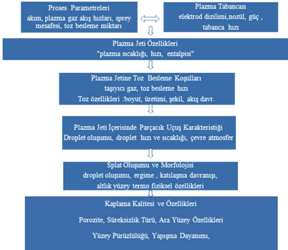
Şekil 3.3. Kaplama kalitesine ve dayanımına etki eden faktörler [15].
