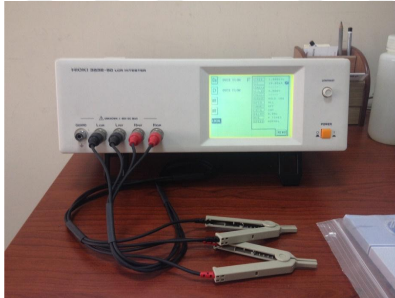
Şekil 5.10. Dielektrik sabiti ölçüm cihazı HIOKI 3532-50 LCR HiTESTER
