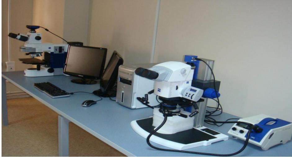
Şekil 5. 16. Optik ve yüzey incelemelerinin yapıldığı ZEIS marka optik ve stereo mikroskop.
