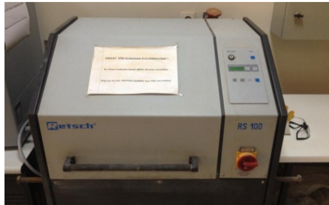
Şekil 5.6. RETSCH marka halkalı değirmen.
