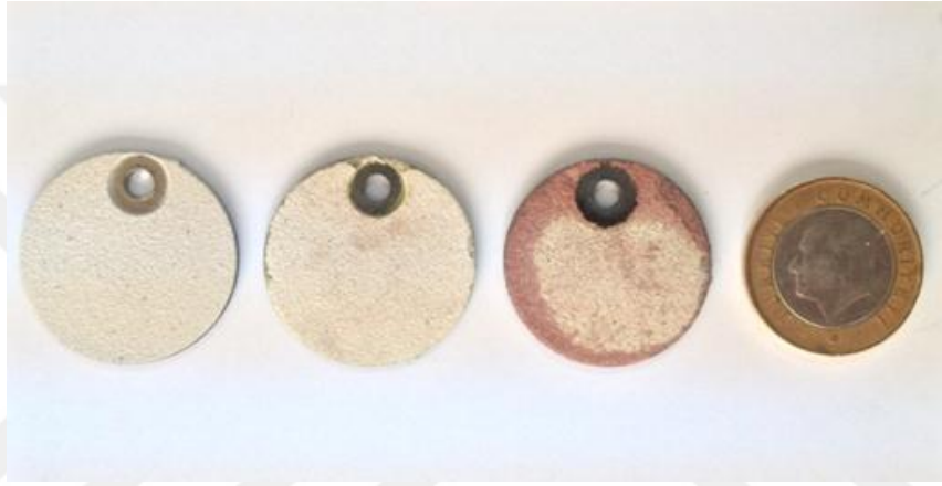
Şekil 5.20. Termal şok testine tabi tutulan numunenin işlem görmemiş hali, 1000°C ve 1200°C’deki termal şok testi sonrası makro görüntüleri.
