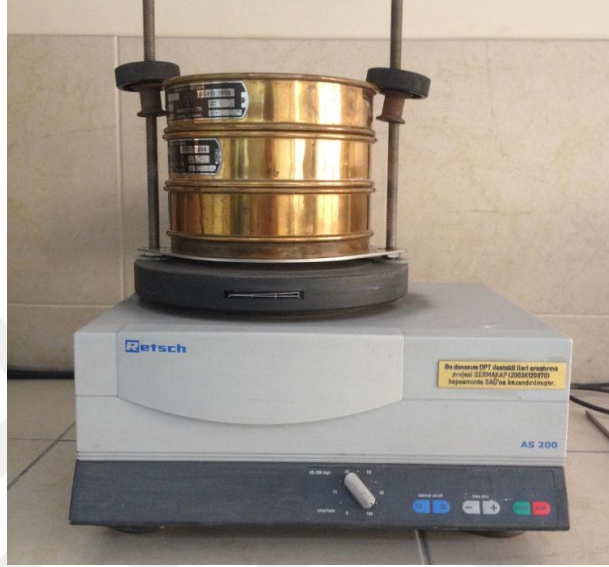
Şekil 5.7. Eleme işleminde kullanılan RETSCH marka titreşimli elek sistemi.
