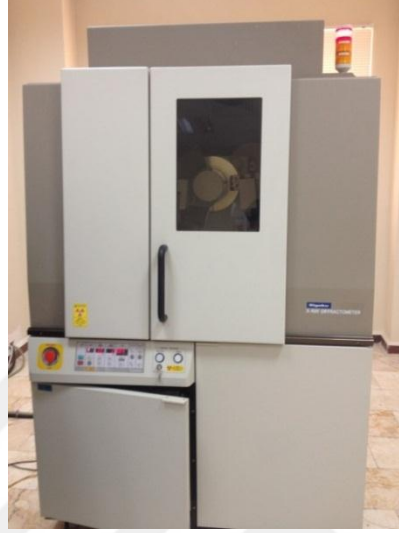
Şekil 5.18. RIGAKU marka X-Ray difraktometre cihazı.
