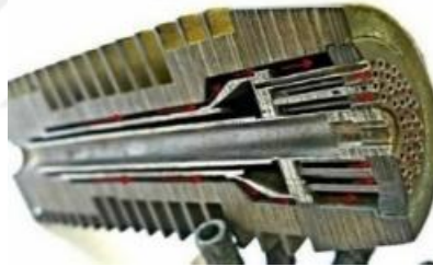
Görsel 3.9 Bethlemen marka yüzey karışimli şaloma başlığı LPG gazı çıkış yolu (http-16).
