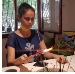
Görsel 4.1 Alevde şekillendirme üretim aşaması, camın ısıtılması anı (Göksu Çınar arşivi,2021).
