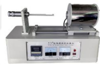
Görsel 3.1 Dilatometre (termal genleşme katsayısı ölçüm cihazı). Maksimum fırın sıcaklığı 1200°C ile 1700°C arasında değişebilmektedir. Termal genleşme katsayısını otomatik olarak hesaplamaktadır. Camı geçiş sıcaklığı ve dilatometrik yumuşama sıcaklığı da ölçülebilmektedir (http-5).
