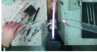
Görsel 4.16 Boru ucunu kapatma işlemi (http-31).
