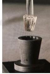
Görsel 4.13 Alevde şekillendirmede kalıpla biçimlendirme yöntemi (Adams, 2005, p. 142).
