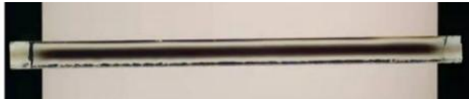
Görsel 3.3 Çevrimiçi polariskop altında içerisinde kalınlık stresi bulunan cam çubuk örneği ( http-6 ).
