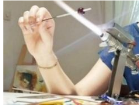
Görsel 4.3 Alevde şekillendirmede üretim aşaması, eriyik camın mandrel üzerinde merkezde tutulması anı (Göksu Çınar arşivi, 2021).
