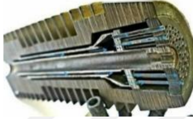
Görsel 3.8 Bethlehem marka yüzey karışimli şaloma başlığı oksijen gazı çıkış yolu (http-16).
