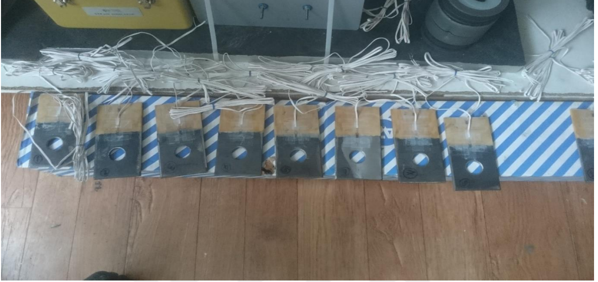
Şekil 2.2 Numunelere strain-gage uygulama noktaları
