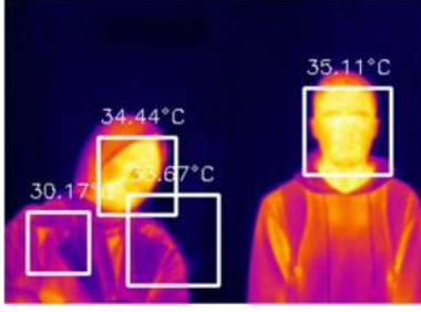
Şekil 51. Haar Cascade ile yatay ve dikey bakan insan yüzü tespiti ve sıcaklık analizi (scaleFactor = 1.01 ve minNeighbors = 1)
