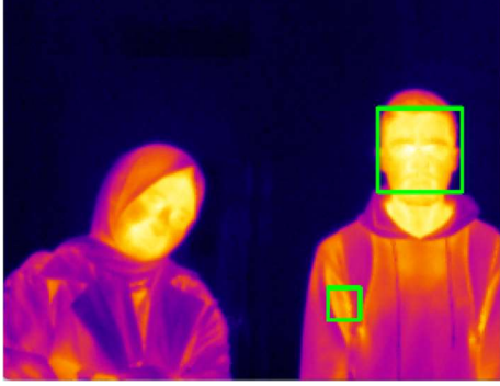
Şekil 61. Haar Cascade ile yatay ve dikey bakan insan yüzü tespiti ve sıcaklık analizi (scaleFactor = 1.05 ve minNeighbors = 25)
