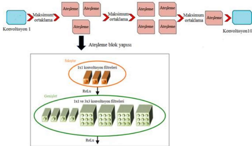
Şekil 41. Ateşleme blok yapısı (SqueezeNet mimarisi örneği) (Huang vd., 2017)
