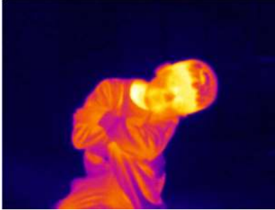
Şekil 57. Haar Cascade ile yan bakan yüz tespiti ve sıcaklık analizi (scaleFactor = 1.05 ve minNeighbors = 5)
