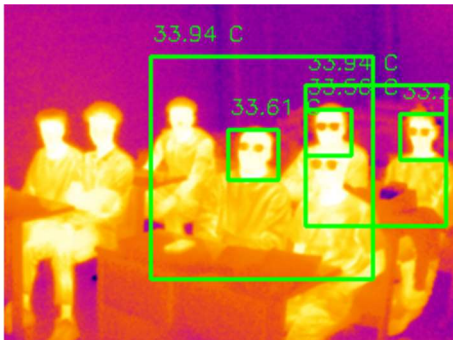
Şekil 48. Haar Cascade çoklu yüz tespiti ve sıcaklık analizi (scaleFactor = 1.01 ve minNeighbors = 1)
