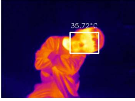
Şekil 71. Deep Learning yana bakan yüz tespiti ve sıcaklık analizi
