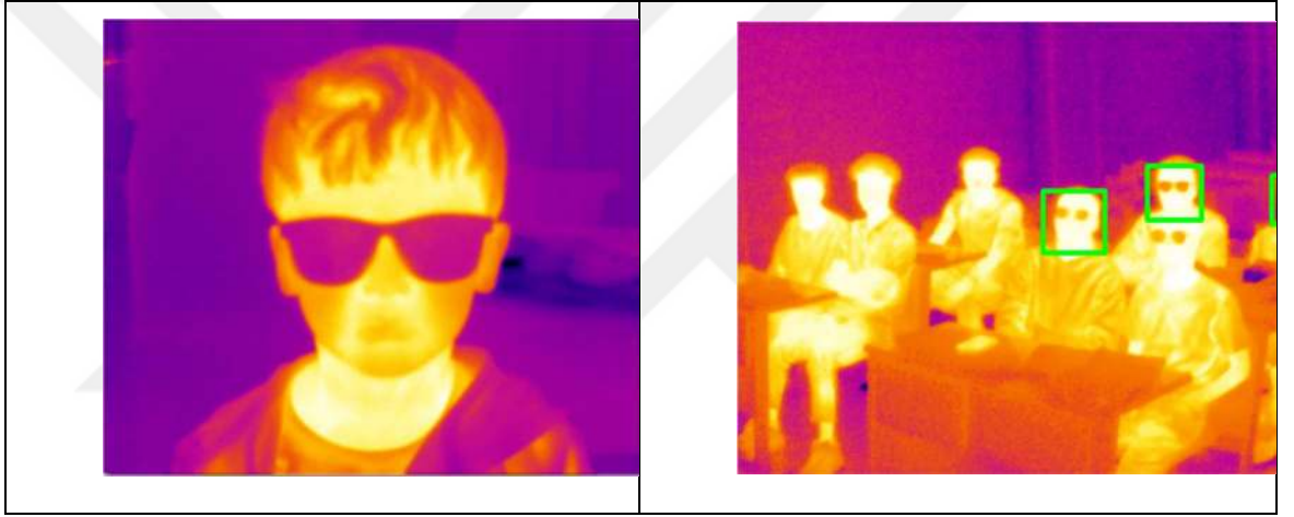
Şekil 45. Haar Cascade yöntemi ile IR görüntülerde tespit edilen yüz bölgeleri. scaleFactor, minNeighbors = 1.05, 25
