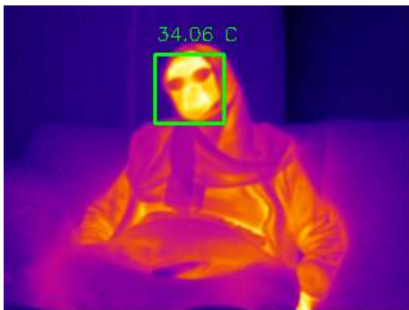
Şekil 60. Haar Cascade ile hafif yan bakan yüz tespiti ve sıcaklık analizi (scaleFactor = 1.05 ve minNeighbors = 25)
