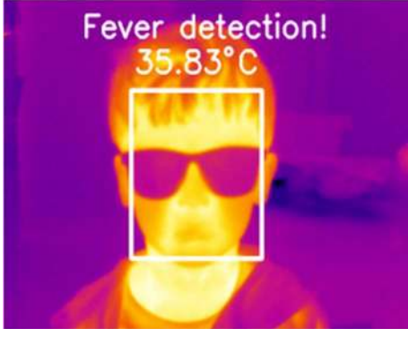
Şekil 67. Deep Learning yüz tespiti ve sıcaklık analizi
