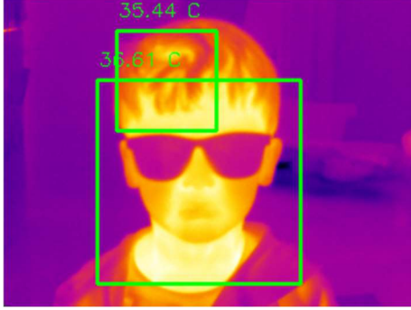
Şekil 49. Haar Cascade tekli yüz tespiti ve sıcaklık analizi (scaleFactor = 1.01 ve minNeighbors = 1)
