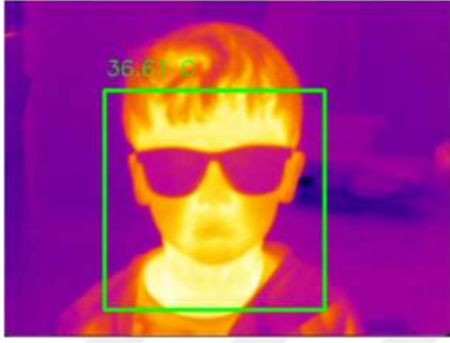
Şekil 54. Haar Cascade ile yüz tespiti ve sıcaklık analizi (scaleFactor = 1.05 ve minNeighbors = 5)
