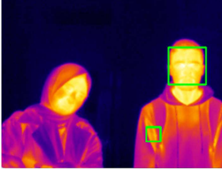
Şekil 56. Haar Cascade ile yatay ve dikey bakan insan yüzü tespiti ve sıcaklık analizi (scaleFactor = 1.05 ve minNeighbors = 5)
