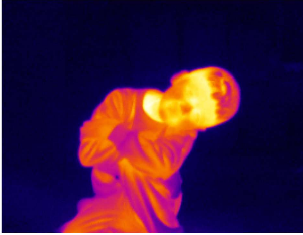
Şekil 62. Haar Cascade ile yan bakan yüz tespiti ve sıcaklık analizi (scaleFactor = 1.05 ve minNeighbors = 25)
