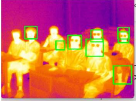
Şekil 53. Haar Cascade çoklu yüz tespiti ve sıcaklık analizi (scaleFactor = 1.05 ve minNeighbors = 5)
