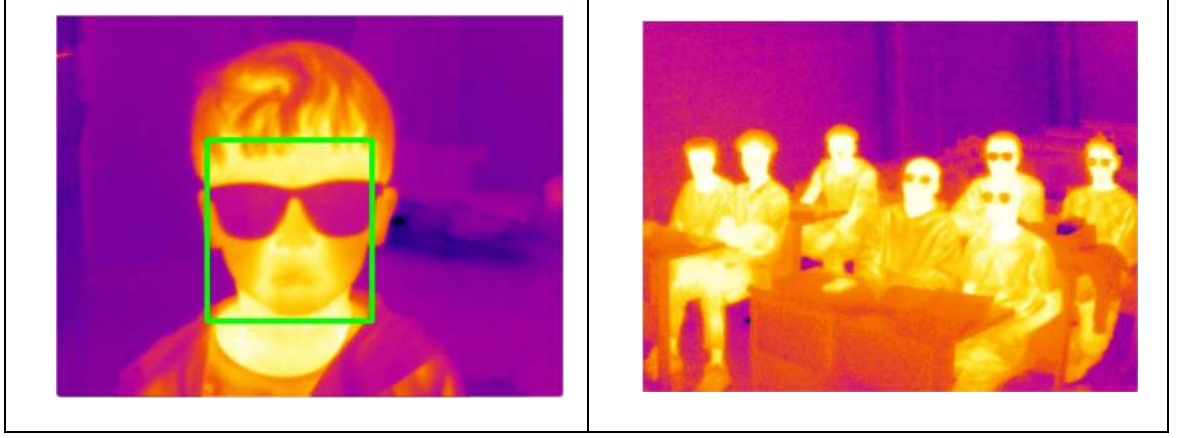
Şekil 47. Derin öğrenme yöntemi ile IR görüntülerde tespit edilen yüz bölgeleri.
