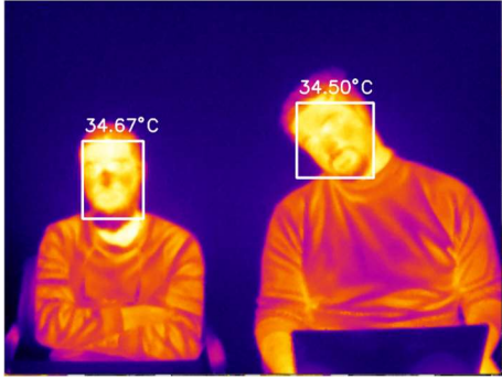
Şekil 70. Deep Learning hafif yana bakan ve ileri bakan yüz tespiti ve sıcaklık analizi
