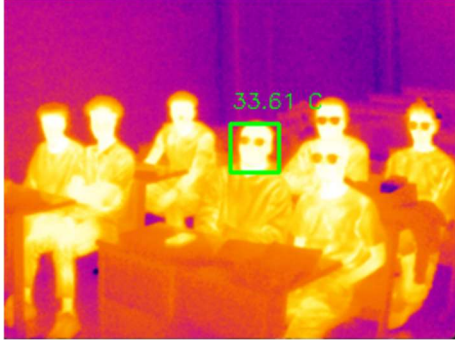
Şekil 58. Haar Cascade çoklu yüz tespiti ve sıcaklık analizi (scaleFactor = 1.05 ve minNeighbors = 25)
