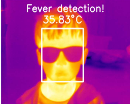
Şekil 67. Deep Learning yüz tespiti ve sıcaklık analizi
