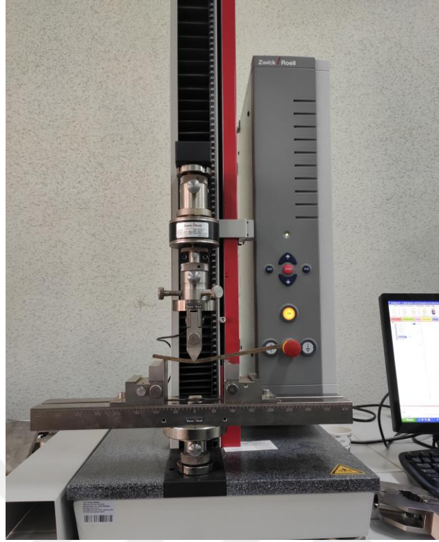
Şekil 3.9. Zwick/Roell Z1.0 test makinası ve eğilme testi.
