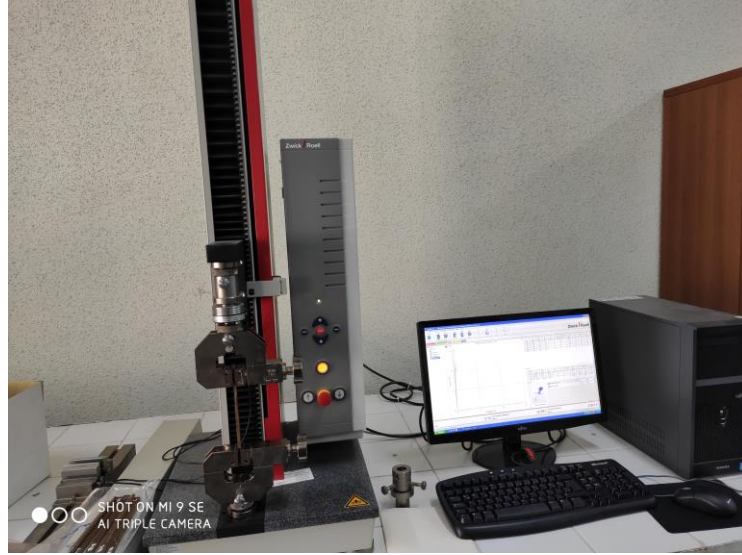
Şekil 3.10. Zwick/Roell Z1.0 test makinası ve çekme deneyi.
