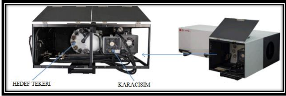
Şekil 2.5. Kolimatör İç Yapısı [37]
