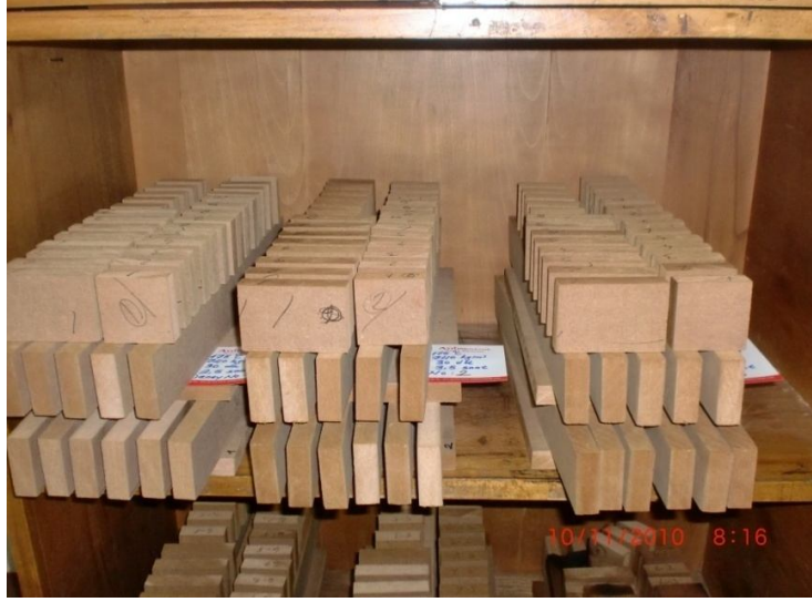
Şekil 3.4 Isıl İşlem uygulanacak deney örnekleri ve dizilişi
