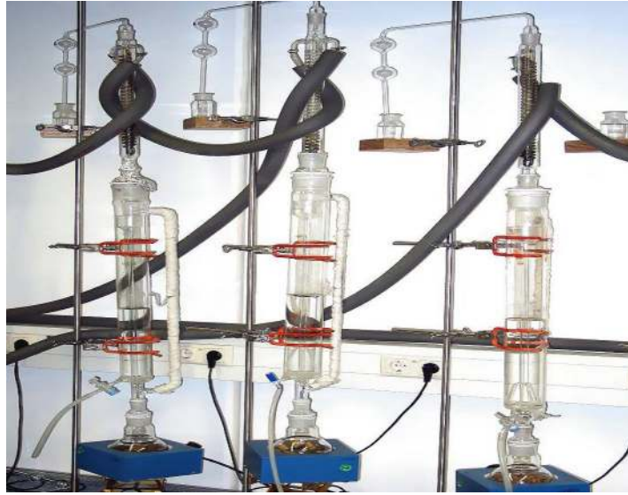
Şekil 3.12 Formaldehit Emisyon Ölçümü için Perforatör test cihazı
