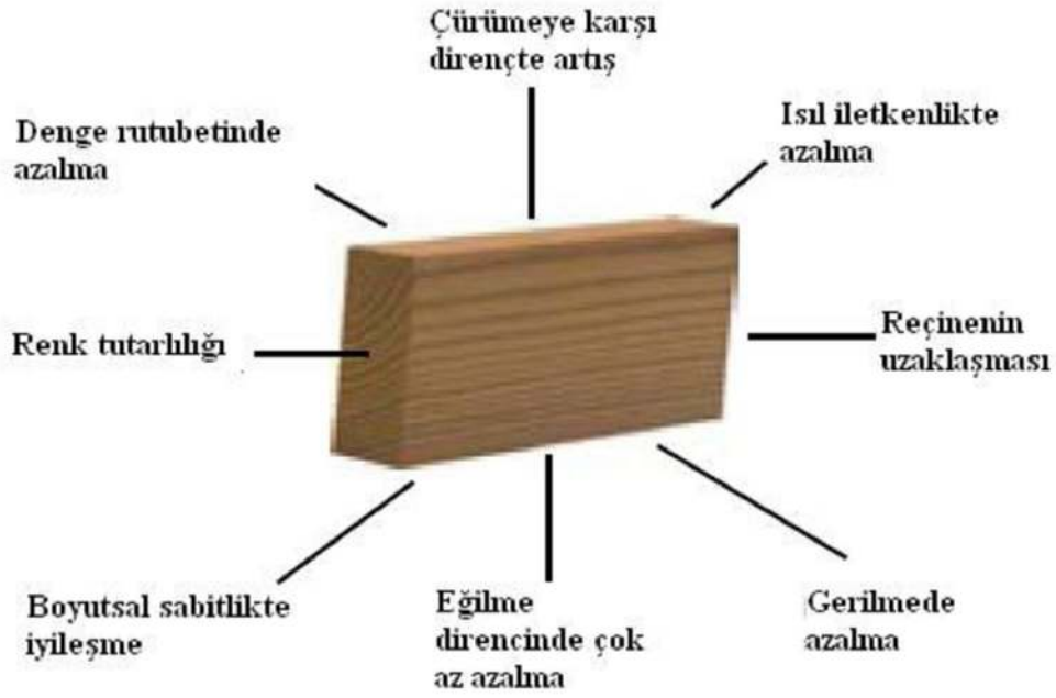
Şekil 1.2 Isıl işlemin ağaç malzemeye kazandırdığı başlıca özellikleri ( http://www.thermowood.fi/ )
