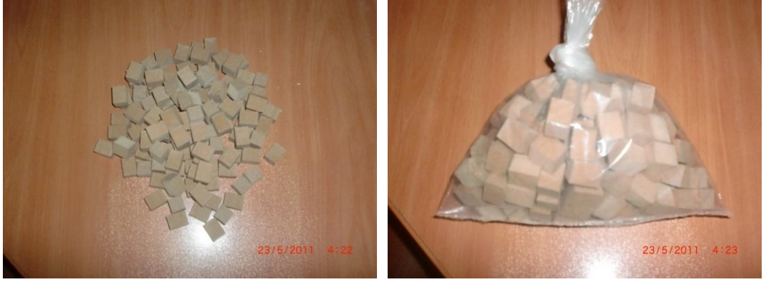
Şekil 3.11 Perforatör testi için kesilen küp şeklindeki parçalar
