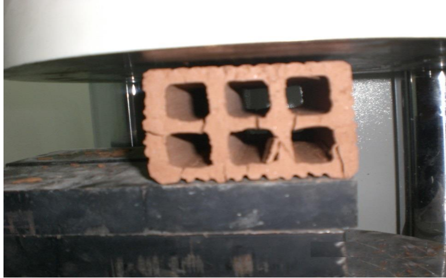
Şekil 4.33. Beton test basıncında kırılmış tuğla numunesi
