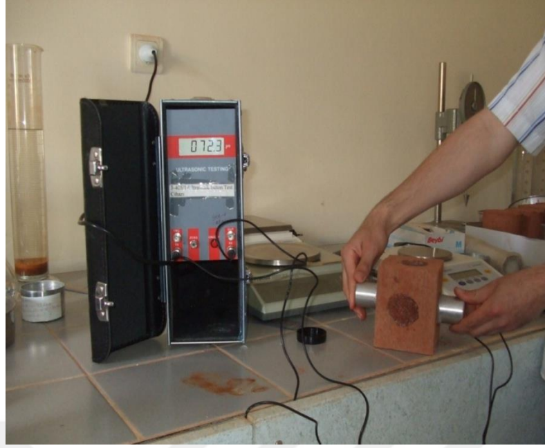
Şekil 3.15. Kare kesitli modifiye proctor numunesinin ultrasonik hız ölçümü
