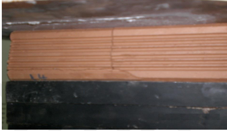
Şekil 4.32. Beton test basıncında kırılmış tuğla numunesi
