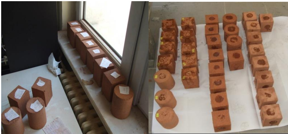
Şekil 3.13. Kare kesitli ve standart proctor kalıplarından çıkarılan numunelerin oda sıcaklığında kurutulması
