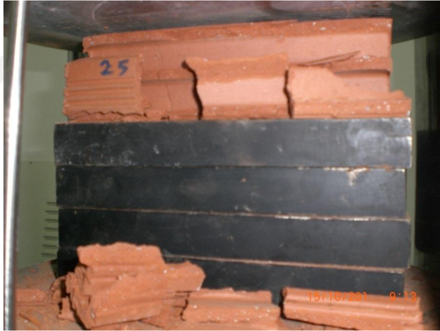
Şekil 4.35. Beton test basıncında kırılmış tuğla numunesi
