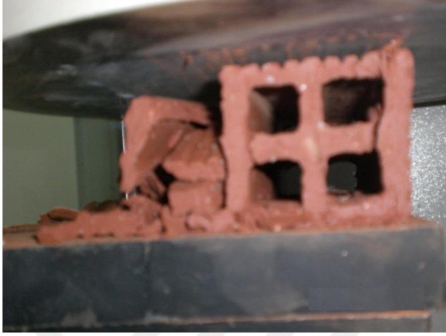
Şekil 4.34. Beton test basıncında kırılmış tuğla numunesi
