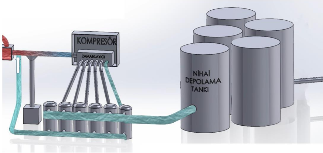
Şekil 4.5. Tasarlanan CO 2 sıkıştırma, sıvılaştırma ve depolama sistemi.
