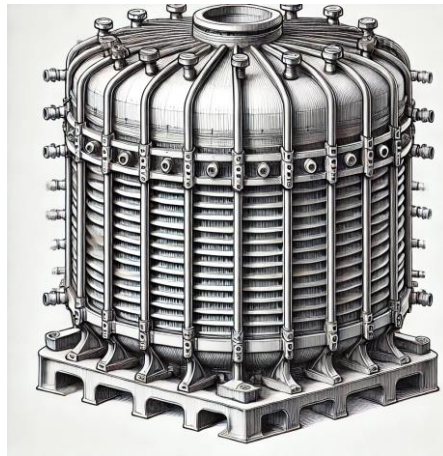
Şekil 4.14. Doğal soğutmalı, kanatlı ve oluklu tank görünümü.
