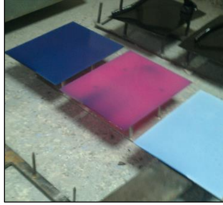
Şekil 5. 5 : Emaye kaplanmış numunelerin, fırına girmeden önce, fırından çıktıktan sonra ve oda şartlarında 10 dakika durduktan sonraki görüntüleri.
