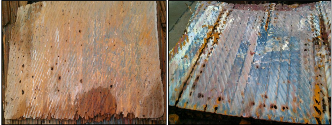
Şekil 2. 4 : Sülfürik korozyonuna uğramış ısı değıştirici plakalar.
