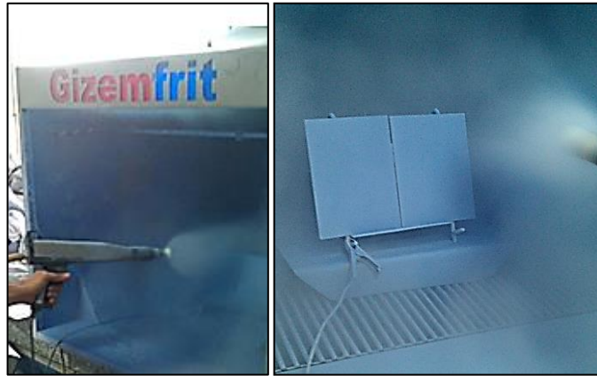
Şekil 5. 4 : Elektrostatik toz spreyleme yöntemi ile kaplama uygulanması.
