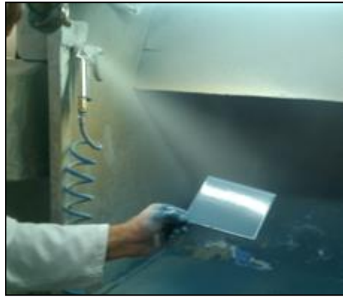
Şekil 5. 3 : Hava destekli spreyleme yöntemi ile kaplama uygulanması.
