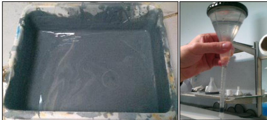
Şekil 5. 2 : Hazırlanan emaye çamuru ve bayer eleği.
