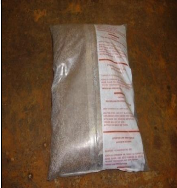
Şekil 2.5 Termit Döküm Tozu.
