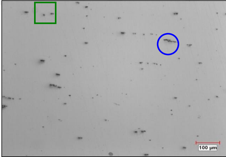
Şekil 3.3 A100 Rayının İnküzyon Durumu (Optik Mikroskop x100).
