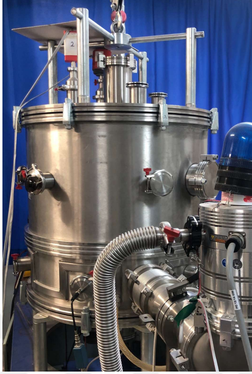
Şekil 3.5 TVA sisteminde kullanılan vakum odası
