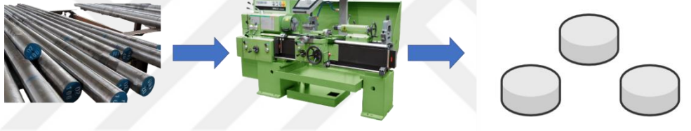
Şekil 4.1.AISI D2 çeliğinin işlenmesi
