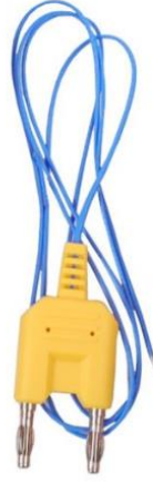
Şekil 3.6. K tipi BRYMEN BKP-60 ölçü aleti termokupl probu
