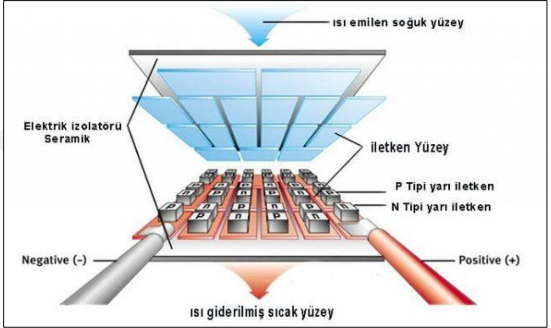
Şekil 1.12. Termoelektrik elemanın iç yapısı (Anonim 2022f)
