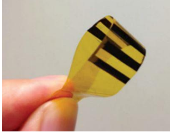
Şekil 1.19. Poliimid üzerine basılmış esnek soğutucu (Lu et al. 2014)
