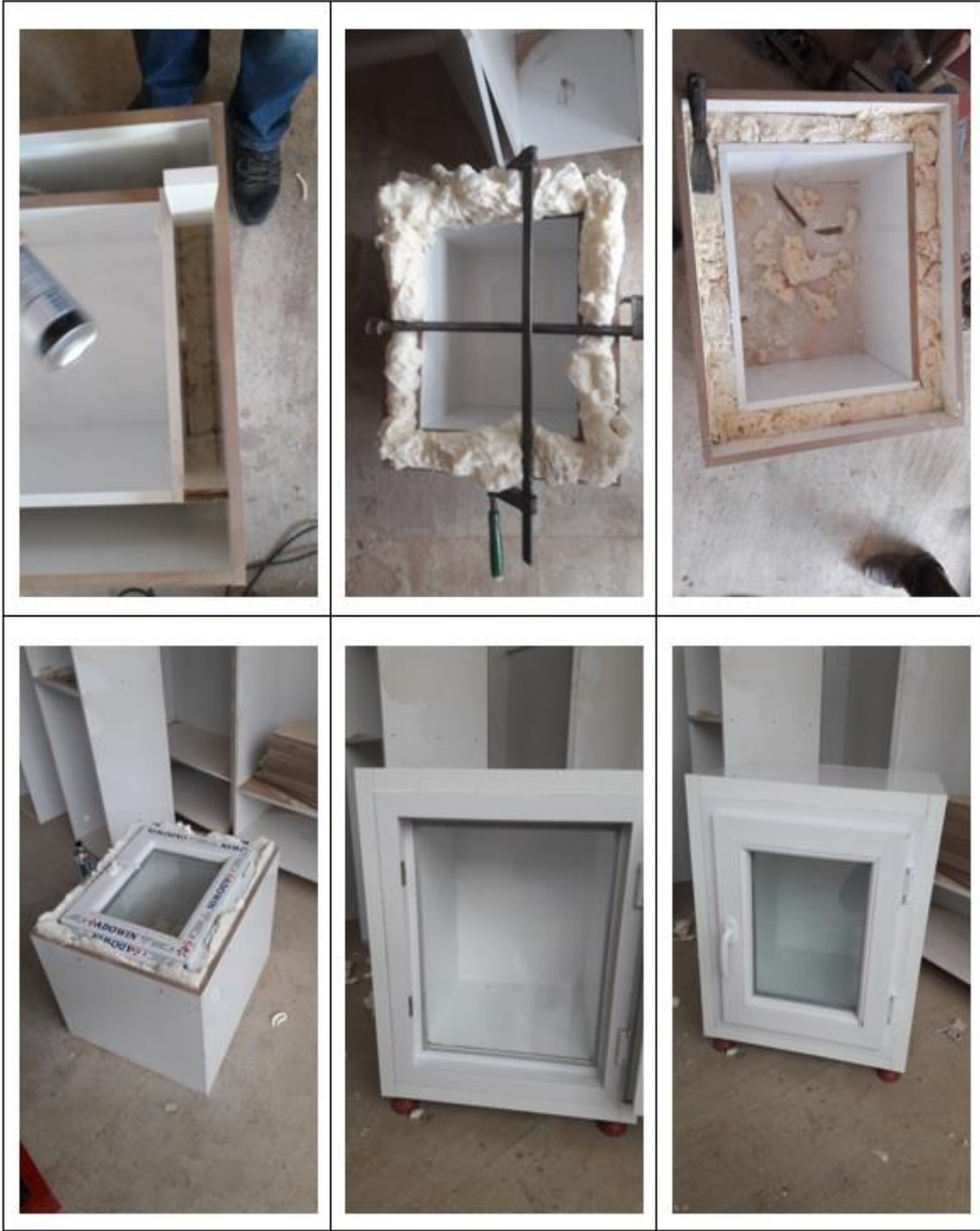
Şekil 2. Soğutucu kabin üretim aşamaları
