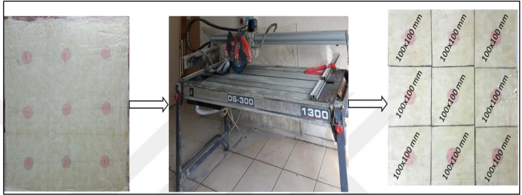
řekil 4.9 Numune kesim ařaması (Kiřisel arřiv, 2019)
