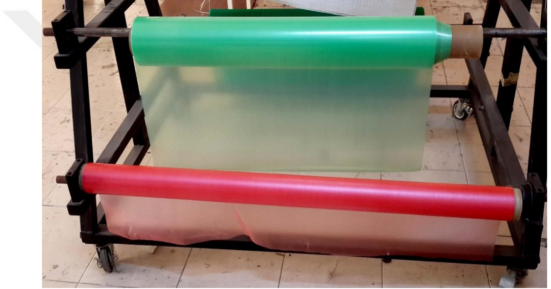
Şekil 3.6 Kırmızı transparan ayırıcı film ve yeşil transparan renkli vakum torbası (Kişisel arşiv, 2019)
