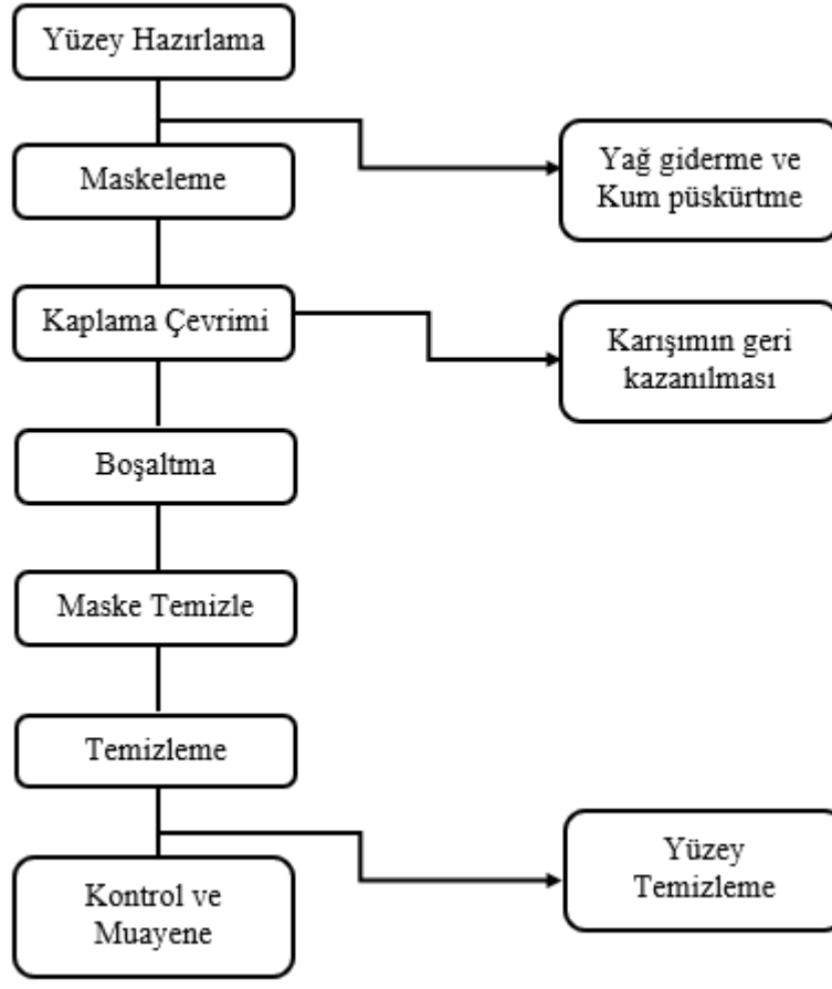
Şekil 3.4. TRD prosesinin genel akım şemasının şematik gösterimi [71].
