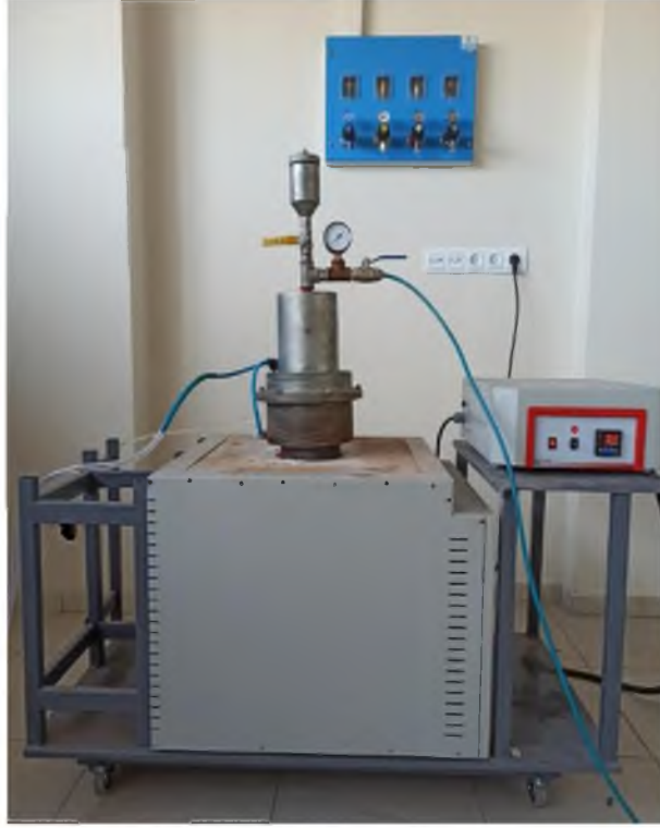
Şekil 4.2. Yüksek sıcaklık fırını
